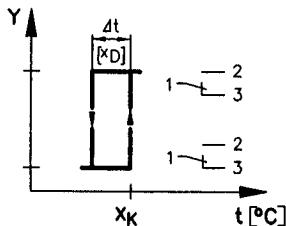
Gehäusedeckel entfernen. Sollwert  $X_K$  und Schalt-differenz  $\Delta t$  auf gewünschten Wert einstellen ( $\Delta t$  von TKM2 : 2 K fest). Einstellung von  $\Delta t$  durch Verschieben von  $X_K$  überprüfen.
